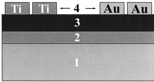
Рис. 1. Схематичне зображення досліджуваної структури: 1 – кремнієва підкладка, 2 – нижній шар металізації, 3 – полімерний шар з C 60 , 4 – верхні омичні контакти.
