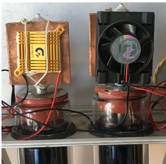
Рис. 2. Фото розміщення термоелектричного модуля на конденсаторі вакуумного колектора.
