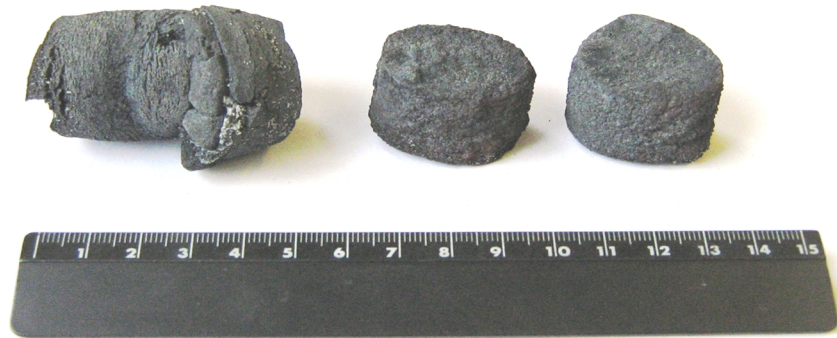
Рис. 2. Зовнішній вигляд зразків, отриманих термічним синтезом із суміші порошків гідриду титану, алюмінію та вуглецю.
