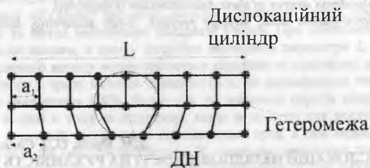
Рис.2. Геометричне представлення дислокації невідповідності на гетеромежі двох епітаксійних плівок
