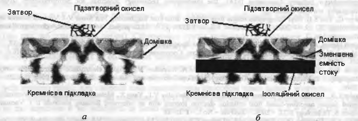
Рис.11. Структура транзисторів: а – стандартного; б – КНІ МОН
