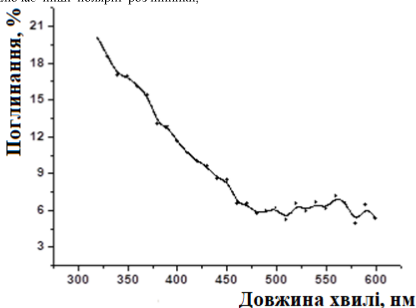
Рис.4. Оптичний спектр пропускання синтезованого оксиду графену.
