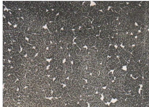
Рис. 5. Мікрофотографія плівки германіда заліза, конденсованої при малих термодинамічних пересиченнях на скол NaCl при T_p=680 К ( h=80 нм) ( \times 10000 ).
