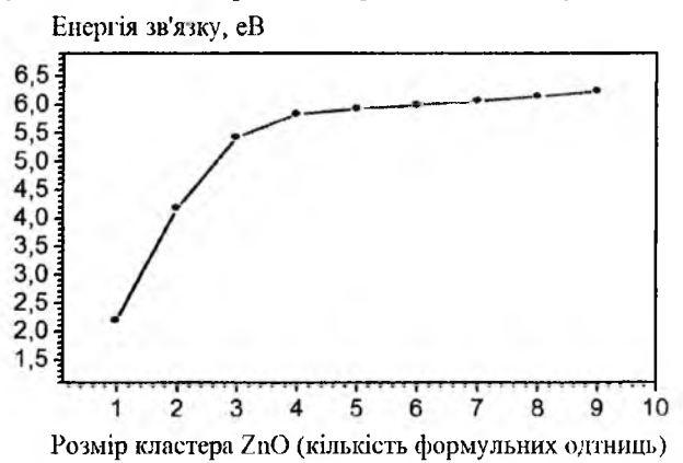
Рис. 12. Енергії зв'язку для найбільш стабільних кластерів Zn_nO_n в залежності від їх розмірів
