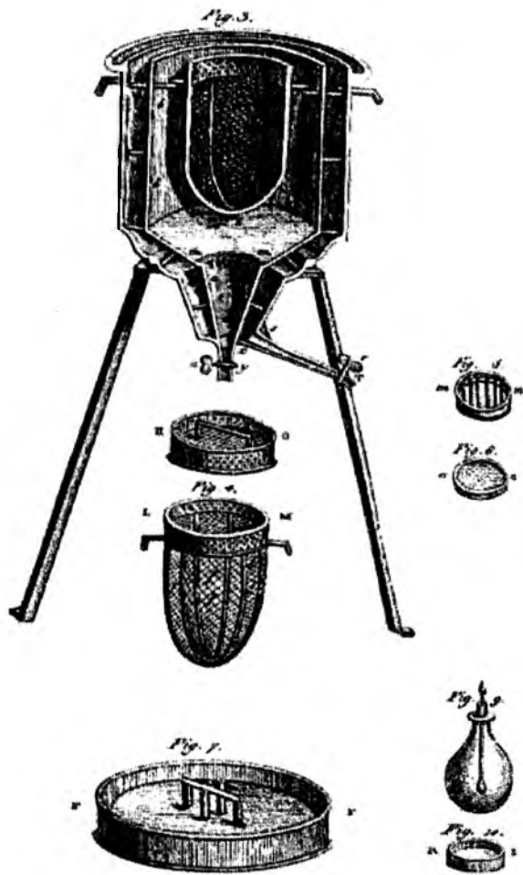
Рис. 19. Перший у світі крижаний калориметр, використаний взимку 1782-1783 Антуаном Лавуазьє і П'єр-Симоном Лапласом, для визначення енергії у формі тепла, що виділяється у різних хімічних перетвореннях; розрахунки базувались на попередньому відкритті Джозефа Блека енергії у формі схованого тепла. Ці експерименти поклали початок термохімії [27].
