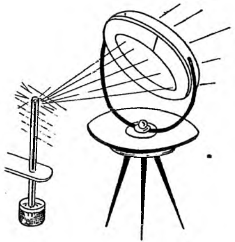
Рис. 14. Дослід Прістлі для одержання кисню з меркурій (II) оксиду під час нагрівання.
