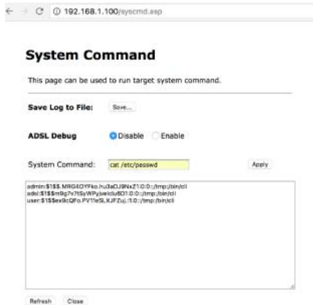
Rys. 10. Interfejs routera dostępny po zalogowaniu za pomocą konta administratora
