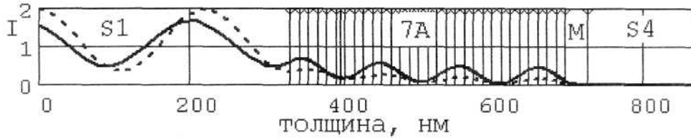
Рис.1. Распределение интенсивности в системе со слоем металла. Сплошная линия - до облучения, пунктир — после, вертикальные отрезки показывают разбиение светочувствительного слоя на подслои для расчета.
