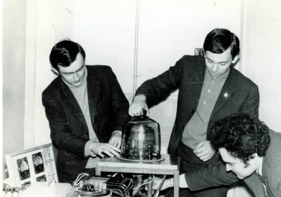
Одна із перших саморобних вакуумних установок для вирощування тонких плівок (1969 р.).
