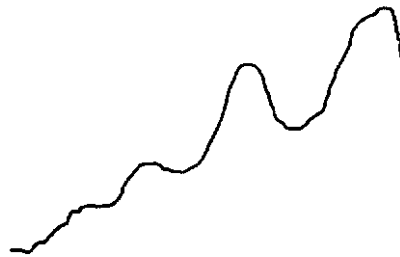
Рис.3. Прозорість алюмінієвої плівки в залежності від товщини за температури 4,2 К. Вздовж осі абсцис – товщина плівок, вздовж осі ординат – інтенсивність (у довільних одиницях) [59]
