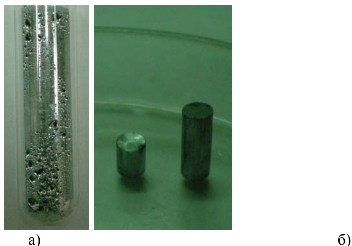
Рис. 1. Синтезований злиток PbTe (а), та пресовані термоелектричні стрижні (б)
