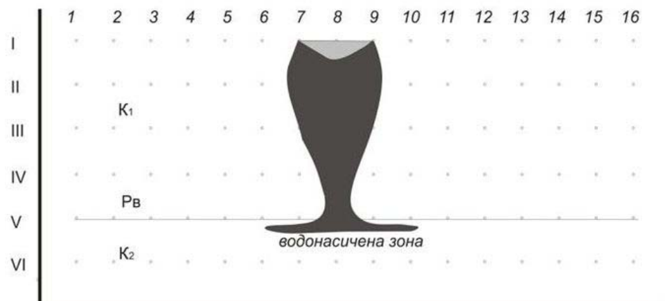
Рис.2 Схема розповсюдження у моделі нафтопродуктів у однорідному ґрунті. Об'єм нафтопродуктів, що вилився до формування капілярної облямівки (Pв) – рівень води у лотку
