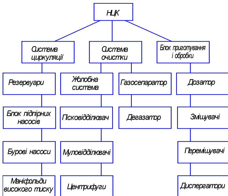
Рис.1. Склад насосно-циркуляційного комплексу (НЦК)
